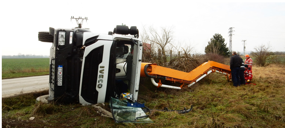
Strhnuté VVN vedenie pri prejazde pod vedeniami a následný pád stožiara (vodič nechal vysunutú betónpumpu a vysokou rýchlosťou strhol telefónne, VN aj VVN vedenie pri Trnave v r. 2018)
