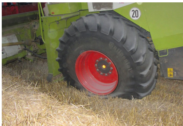
Kontakt kombajna s 22 kV vedením
