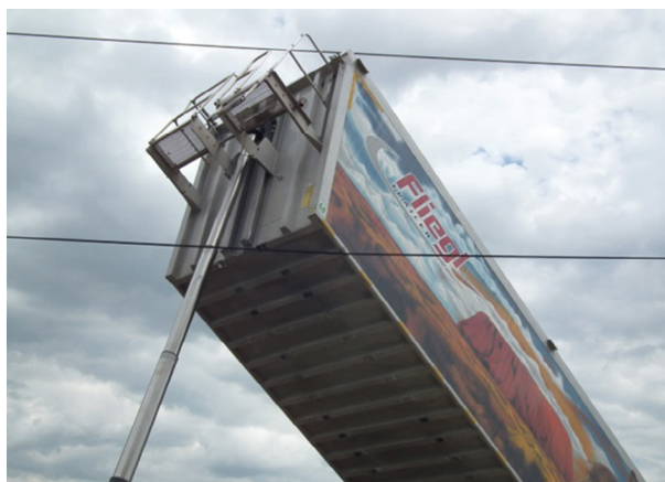
Kontakt s 22 kV vedením
