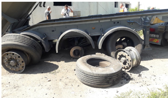
Pneumatiky po dotyku korby s vedením 22 kV
